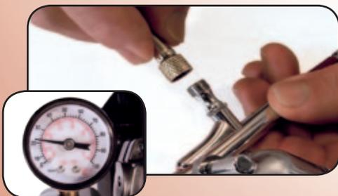
Une fois le godet en place, raccordez l'aérographe à un flexible, lui-même raccordé à une source appropriée d'air comprimé. La pression d'air recommandée est de 1,5 bar. Cette pression peut être modifiée en fonction de la dilution de la peinture et de la surface à peindre, sans jamais excéder 4 bar.
