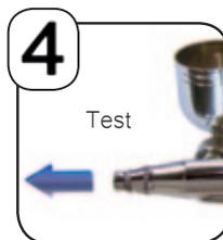
Commencez toujours par verser quelques gouttes de diluant dans votre godet. Ajoutez ensuite quelques gouttes de peinture puis mélangez l'ensemble à l'aide d'un pinceau. Testez l'application sur un support lisse. Si votre mélange est trop fluide ou trop transparent, rajoutez progressivement quelques gouttes de peinture. Dans la gamme Prince-August Air vous trouverez le diluant P061, adapté à la peinture acrylique, en 32 et 200ml.
