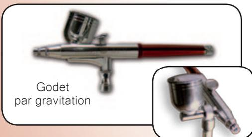
Le godet par gravitation de 5ml, plus léger, vous offre une ergonomie plus adaptée à un travail de précision. Sa position, déportée, permet de ne jamais masquer la surface à peindre. Attention, ne jamais forcer le godet dans la recherche de la position souhaitée, ajustez-le à l'aide de l'écrou de serrage (30).
